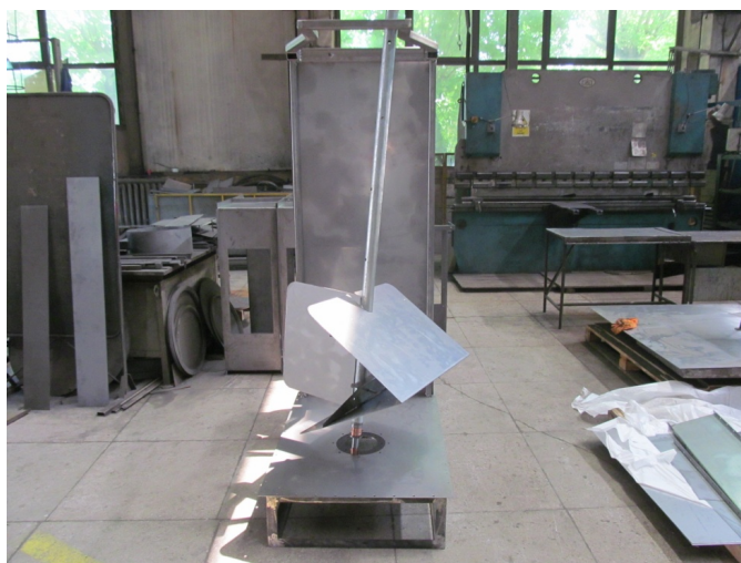
Fig. 1 Amestecătorul în faza de construcție.
