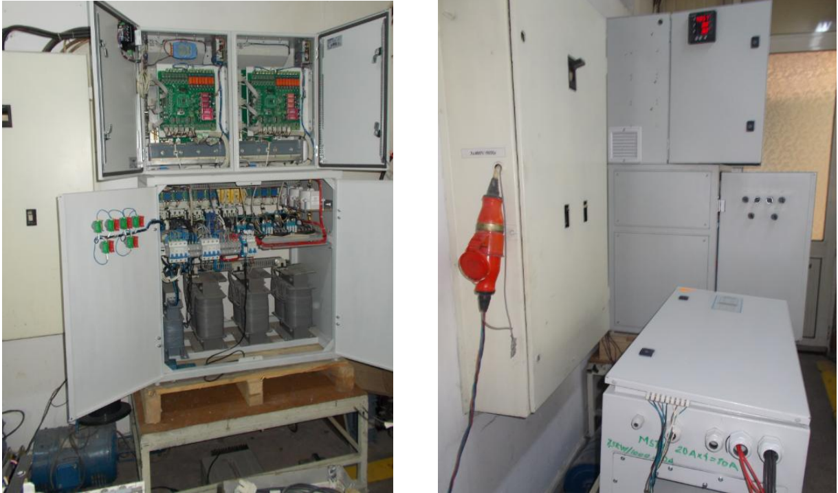
Figura 34. Vederi ale sistemului experimentat și a inverterului utilizat ca sarcină împreună cu un motor asincron
