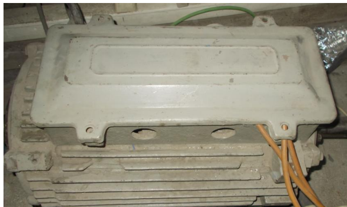
Figura 35. Motor asincron utilizat ca sarcină(20kW)
